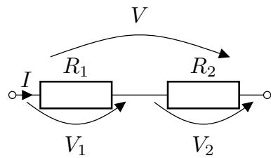
上図のように、抵抗  $R_1, R_2$  にかかる電圧をそれぞれ  $V_1, V_2$ 、全体の電流と電圧をそれぞれ  $I, V$  とすると、それぞれの抵抗について、オームの法則から、
