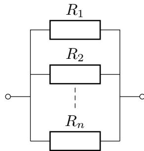
上図のように抵抗値がそれぞれ  $R_1, R_2, \dots, R_n$  である  $n$  個の抵抗を並列に接続した場合、その合成抵抗  $R_c$  と、 $R_1, R_2, \dots, R_n$  との関係は、以下で与えられる。
