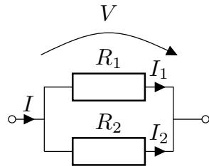
上図のように、抵抗  $R_1, R_2$  に流れる電流をそれぞれ  $I_1, I_2$ 、全体の電流と電圧をそれぞれ  $I, V$  とすると、それぞれの抵抗について、オームの法則から、
