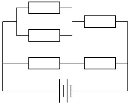
5つの抵抗が左図に示すように接続された回路があったとする。それぞれの抵抗の抵抗値と、電池の起電力は分かっているものとして、回路全体に流れる電流を求めるとき、どのようにすればよいだろうか。
